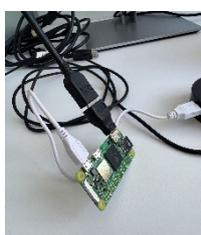
In der Arbeit haben wir mehrere kleinere Projekte gehabt: Unter anderem haben wir ein PickByLight Konzept programmiert, welches eine Anleitung zeigt und die entsprechend benötigten Teile visuell anzeigt. Den Webserver mit den Anleitungen haben wir auf einem RaspberryPi Zero laufen lassen, mit dem dann theoretisch über die Ein- und Ausgänge des SBC die entsprechenden Lampen
